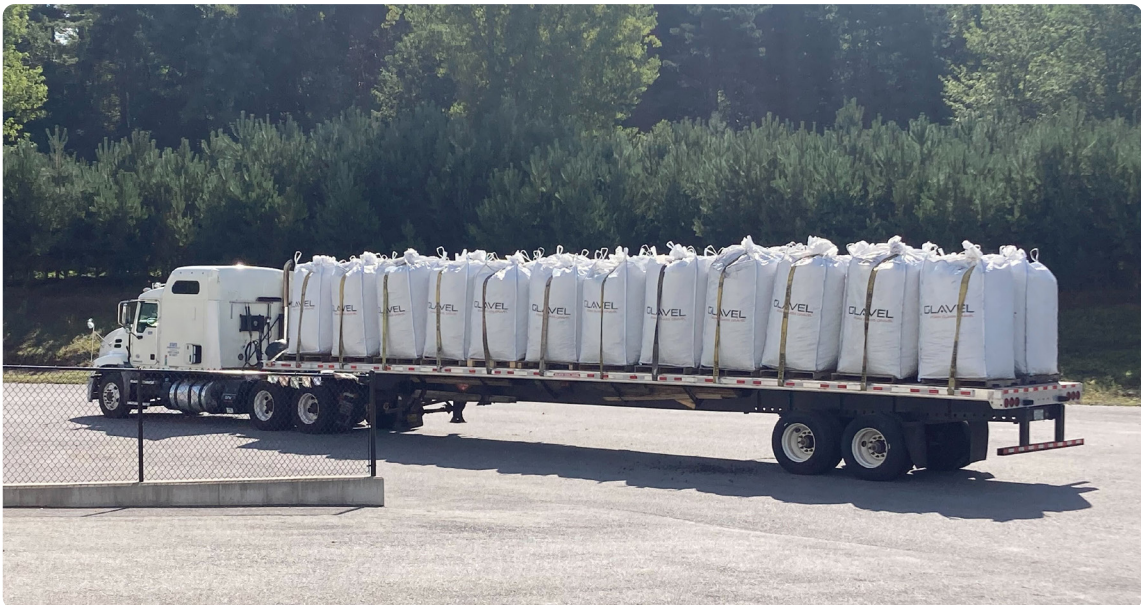
Livraison en sacs, 55 m 3 par camion
